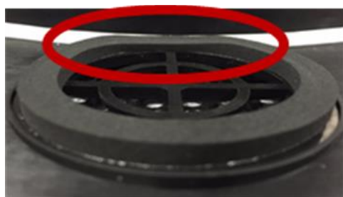
Fig. 2. Exempel på en deformerad inre packning på 3M™ Versaflo™ TR-6XXX filter.
